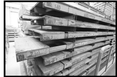
Steel Pallet สามารถเลื่อนปรับความยาวได้ เพื่อเป็นการลดการผลิต Steel Pallet หลายๆ ขนาด
